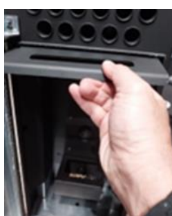
Rysunek 27 - Demontaż przerywacza płomienia
