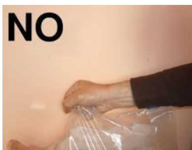
Rys. 11 - Nieprawidłowe otwarcie worka z granulatem
