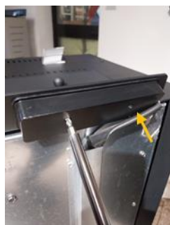
Wykres 181 - Wykręcenie z obudowy wyświetlacza
