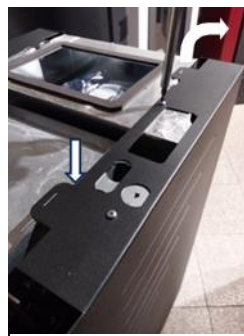
Rysunek 22 - Zdejmowanie ściany bocznej
