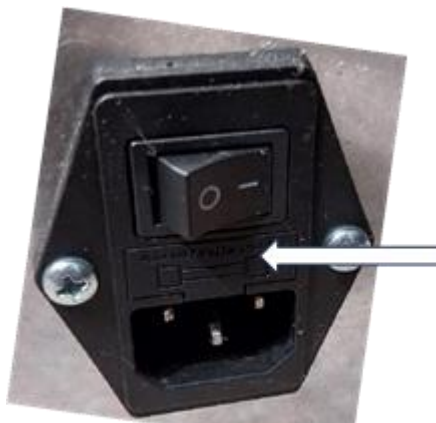
Rys. 46 - Okienko z bezpiecznikami do usunięcia
