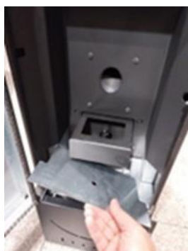
Rysunek 29 - Zdejmowanie pokrywy
