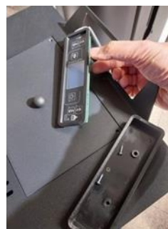
Rysunek 19 - Wyjmowanie wyświetlacza
