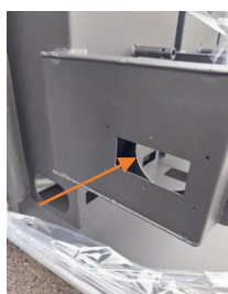
Rys. 39 - Czyszczenie wnętrza skrzynki
