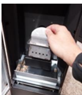
Rysunek 25 - Usuwanie paleniska
