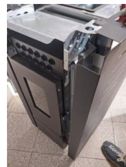
Rysunek 23 - Zdejmowanie ściany bocznej przez
