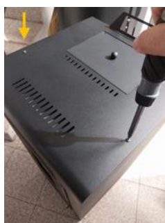
Rysunek 20 - Zdejmowanie górnej części
