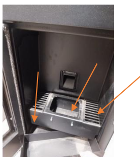
Rys. 18 - Czyszczenie przestrzeni wokół paleniska
