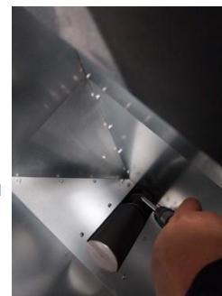
Rys. 20 - Czyszczenie zbiornika i ślimaka
