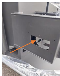
Rys. 39 - Czyszczenie wnętrza skrzynki
