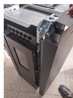
Rys. 26 - Demontaż panelu przez pociągnięcie do góry
