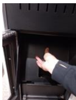
Rys. 35 - Demontaż osłony ochronnej korpusu grzewczego.
