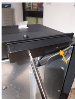
Rys. 21 - Demontaż obudowy pulpitu wyświetlacza
