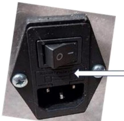
Rys. 46 - Okienko z bezpiecznikami do usunięcia
